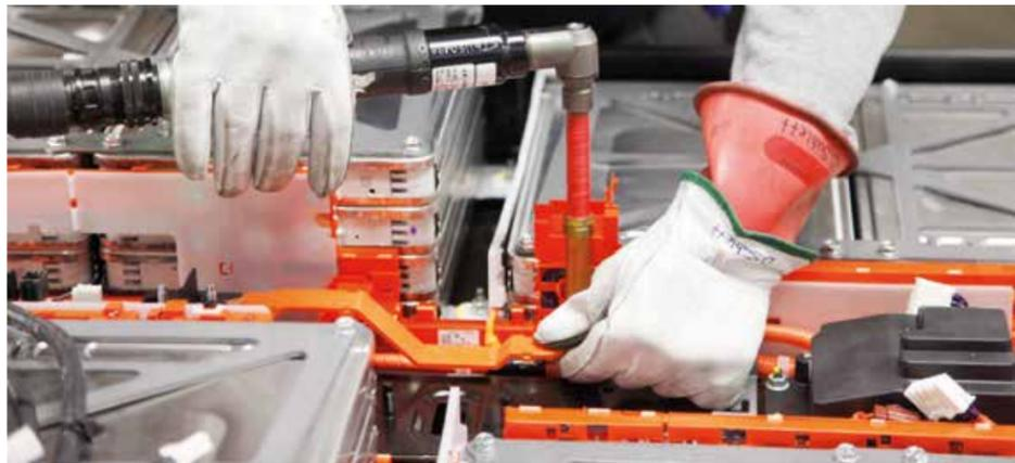
uma tem formato diferente, de acordo com a fabricante. Antes de mais nada, é necessário desenergizá-la, desconectá-la de uma série de cabos, tirar todas as chapas e, a partir daí, mexer nas células”, destaca.
