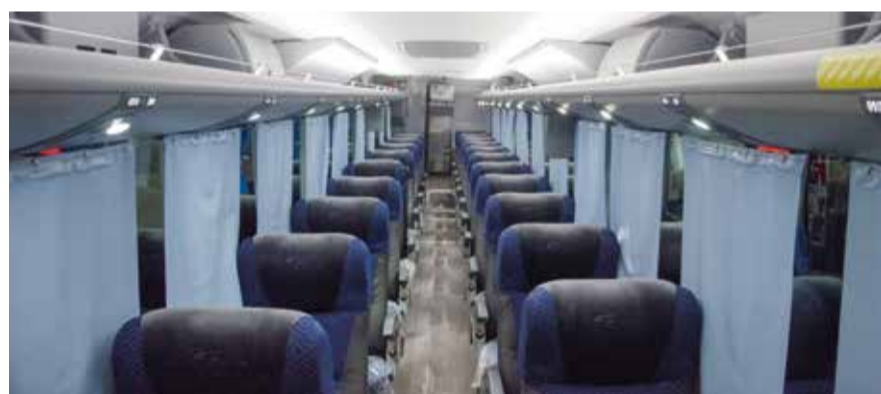
A bordo, ônibus traz alguns dos sistemas de biossegurança da Marcopolo, entre eles, cortina antimicrobiana
