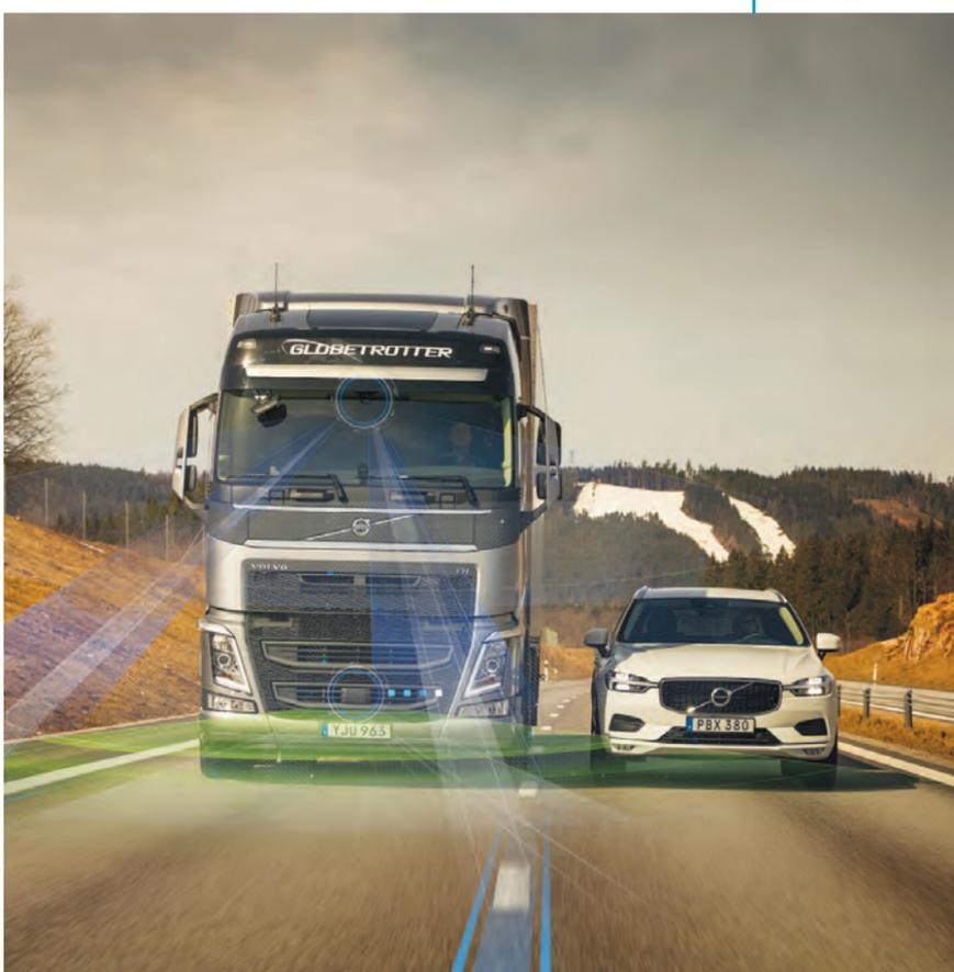
Câmera, radar e sensores frontais ajudam o motorista a manter o veículo dentro dos limites da faixa, e o sistema corrige a direção do Volvo se necessário
